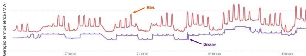
Figura 21: Despacho solicitado pelo modelo Dessem vs. efetivamente realizado pelo time da NOS – Fonte: Volt Robotics<sup>25</sup>
